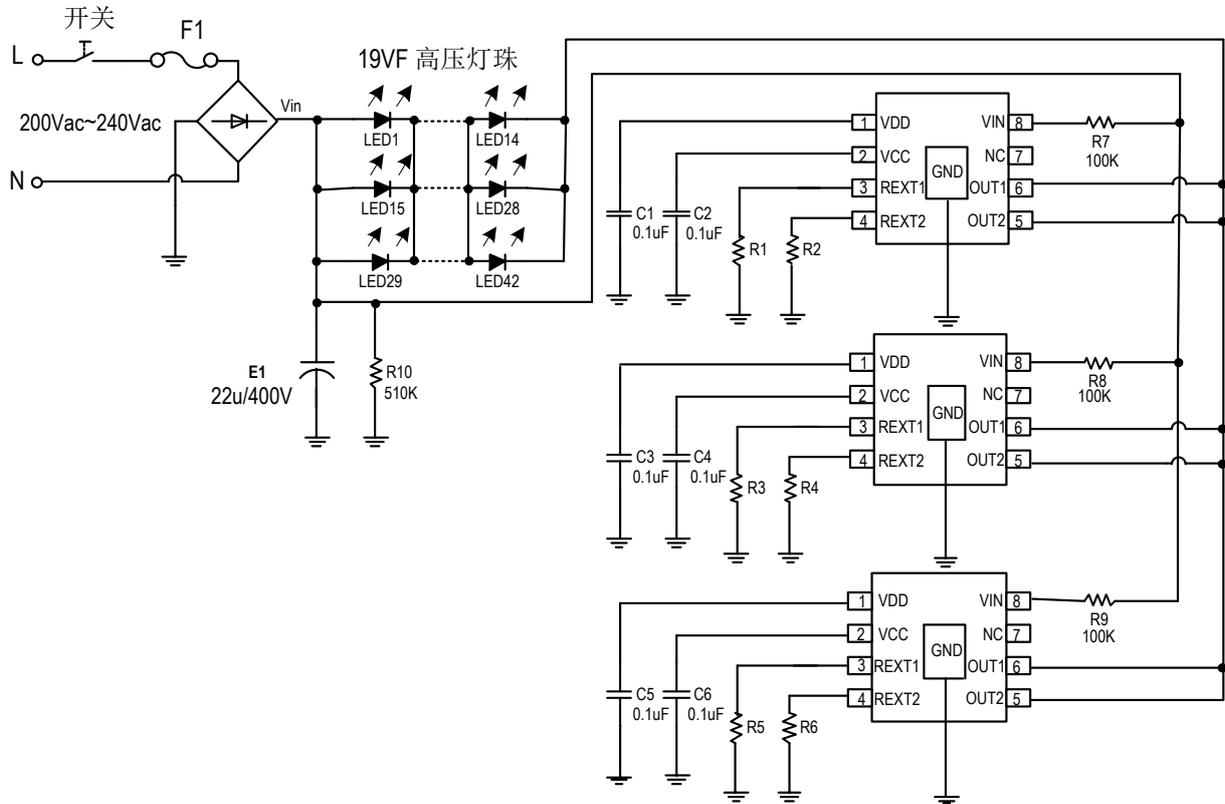
图5 SM2212EB 多芯片并联 典型应用电路图
