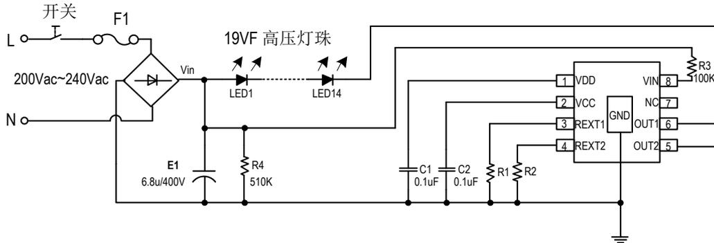
图3 SM2212EB 2段调光典型应用电路图
